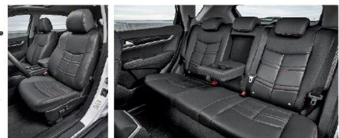
Перед вами – интерьер автомобиля в максимальной комплектации. Более доступный вариант снабжен сиденьями с тканевой обивкой и комбинацией приборов попроще с подслеповатым дисплеем вместо спидометра и компоновкой на манер приборов нынешнего поколения Renault Clio
