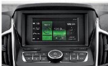
Помимо АКП японского Aisin, для AX7 доступна и 5-ступенчатая «механика» разработки PSA. Медиасистема с 7-дюймовым сенсорным экраном и 6 динамиками устанавливается на все версии AX7, представленные в России. В наличии разъемы USB и Aux
